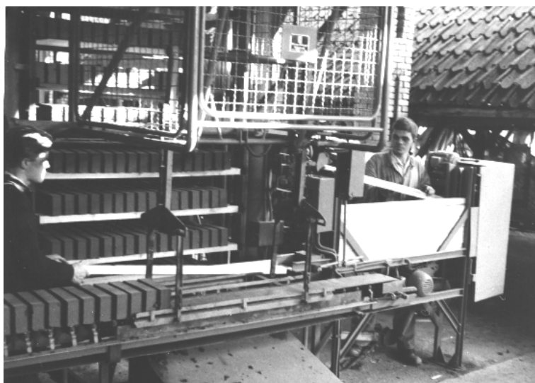
Jan en Henk Scholten bij de "broodjes"-snijmachine. De broodjes uit deze machine werden eerst gedroogd en dan in de ringoven gebakken.
